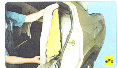
3. Снимите мягкую облицовку задней стойки...
