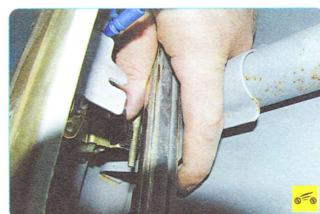
6. ...и выведите резьбовой конец тяги наружной ручки из наконечника.
