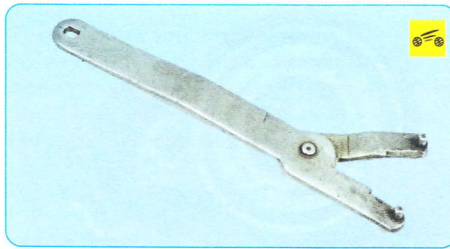
Рис. 12.6. Универсальное приспособление для фиксации ротора компрессора
