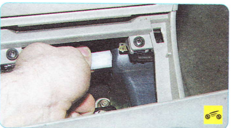
12. Отсоедините колодку жгута проводов от розетки для дополнительных электропотребителей.
