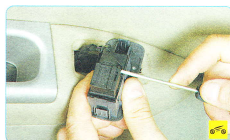
8. Нажав на фиксатор колодки жгута проводов переключателя управления стеклоподъемником задней двери...
