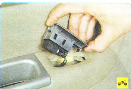
7. ...извлеките переключатель из проема подлокотника, преодолевая упругое сопротивление его фиксаторов.
