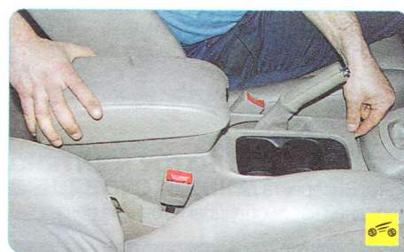
8. Выведите фиксаторы на переднем краю задней части облицовки тоннеля пола из зацепления с ее передней частью...
