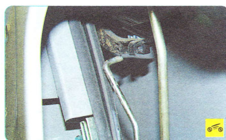
4. ...и выведите тягу из отверстия пластмассового рычага выключателя замка передней двери.
