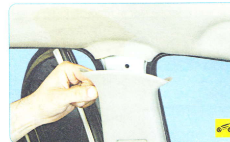
13. Снимите верхнюю облицовку средней стойки кузова (см. «Снятие и установка облицовок салона», с. 274).
