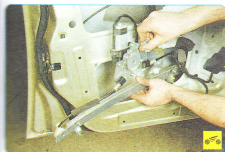
10. ...и извлеките стеклоподъемник через технологическое отверстие во внутренней панели двери.
