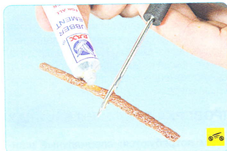
8. Нанесите на жгут слой клея из набора. Поверхность отверстия в шине также обработайте клеем.
