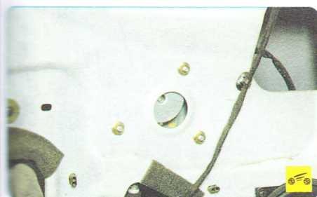
9. Отверните три гайки крепления кронштейна моторедуктора...
