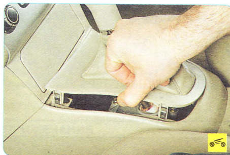
3. ...выведите фиксаторы из зацепления с краем гнезда в облицовке тоннеля пола...
