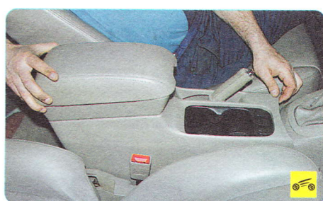
9. ...сдвиньте заднюю часть движением вверх и назад...
