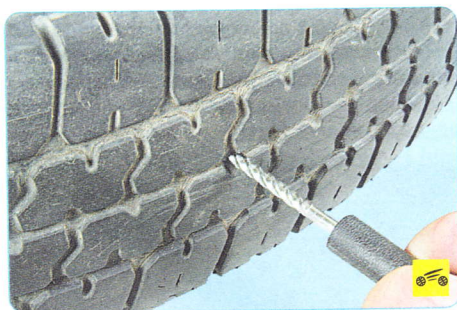
3. Обработайте рашпилем внутреннюю поверхность отверстия. После обработки поверхность будет очищена от грязи, ржавчины и иметь ровные края.
