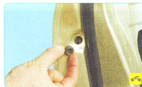
8. ...извлеките резиновую заглушку из отверстия в заднем торце двери.
