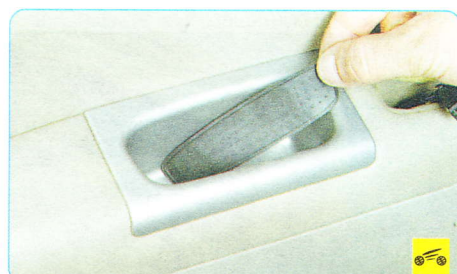
10. Извлеките со дна рукоятки в подлокотнике декоративную заглушку.
