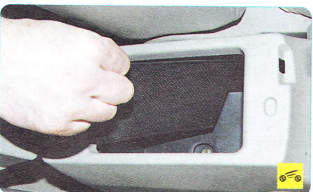
6. Извлеките со дна ящика резиновую накладку.
