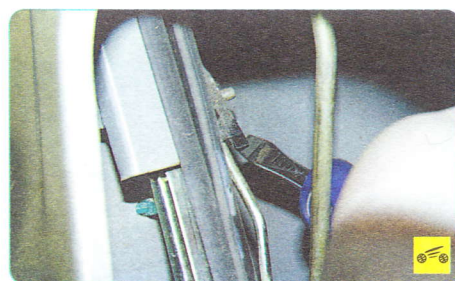
3. Отожмите отверткой пластмассовый фиксатор...
