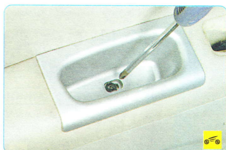
11. Выверните винт крепления облицовки рукоятки подлокотника...
