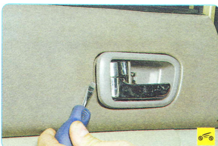
4. ...и поддев отверткой облицовку внутренней ручки замка...
