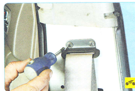
8. Выверните два винта крепления направляющей ремня безопасности...
