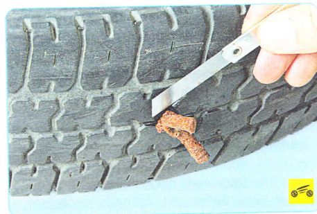
12. Обрежьте оставшиеся на поверхности концы жгута заподлицо с протектором.
