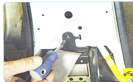
11. ...выверните винт верхнего крепления катушки...
