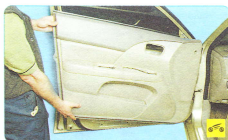
1. Поднимите стекло в крайнее верхнее положение и снимите обивку передней двери (см. «Снятие и установка обивки передней двери», с. 250).
