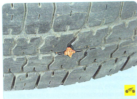
13. Подождите указанное в прилагаемой к ремонтному набору инструкции время, необходимое для полимеризации клея, и накачайте колесо до рекомендуемого давления.
